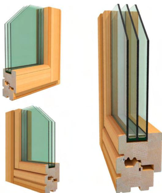
Modello del serramento in legno, spessore mm. 90, tripla battuta e doppia camera, vetro accoppiato mm. 4+4 antisfondamento, camera da mm. 15 con gas argon, vetro mm. 4, camera da mm. 15 con
